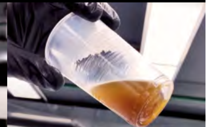
第一次冲洗后的油
